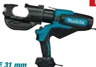
**DTC301ZK** : Pression de sertissage : 120 Kn - Capacité d'ouverture des mâchoires 31 mm - Capacité de sertissage Cu Ø 19,5mm (300 mm<sup>2</sup>) / Al Ø 19,5 mm (300 mm<sup>2</sup>) 13 matrices de sertissage en option - 6,8 à 7,1 kg
