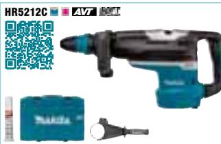
**HR5212C** : 1510 W - béton/trépan 52/160 mm 9 m/s<sup>2</sup> - 150 à 310 tr/min. - 1100 à 2250 cps/min. - 20 J - 11,9 kg. Livré avec 1 poignée, 1 graisse à forêt, 1 poignée latérale en coffret
