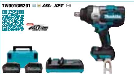
**TW001GM201** : Carré d'entraînement 3/4" - serrage 1800 Nm - desserrage 2050 Nm - M10 à M36 - 0 à 2500 cps/min - 0 à 1800 tr/min - 3,9 à 5,1 kg Livrée avec 2 batteries 40V max XGT 4 Ah et 1 chargeur rapide en coffret MAKPAC
