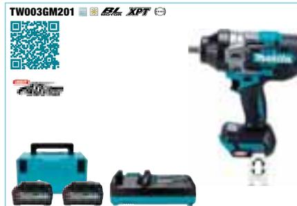
**TW003GM201** : Carré 1/2" - serrage 1360 Nm - desserrage 1600 Nm - M10 à M36 - 0 à 2400 cps/min - 0 à 1800 tr/min - 3,8 à 5 kg Livrée avec 2 batteries 40V max 4 Ah, 1 chargeur rapide en MAKPAC
