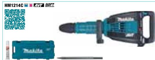
**HM1214C** : 1510 W - 950 à 1900 cps/min. - 19,9 J - 8 m/s<sup>2</sup> - 12,3 kg. Livré avec 1 pointe à béton, 1 graisse à forêt en coffret
