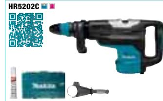
**HR5202C** : 1510 W - béton/trépan 52/160 mm 17 m/s<sup>2</sup> - 150 à 310 tr/min. - 1100 à 2250 cps/min. - 19,1 J - 10,9 kg. Livré avec 1 poignée, 1 graisse à forêt, 1 poignée latérale en coffret
