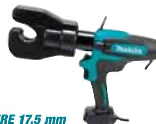
**DTC303ZK** : Pression de sertissage : 60 Kn - Capacité d'ouverture des mâchoires 17,5 mm - Capacité de sertissage Cu Ø 17,5 mm (240 mm<sup>2</sup>) / Al Ø 17,5 mm (240 mm<sup>2</sup>) - 5,3 à 5,7 kg
