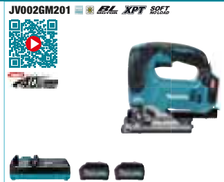
JV002GM201 : 800 W - capacité de coupe bois/acier/alu/ : 135/10/20 mm - haut. de course 26 mm Livrée avec 2 batteries 40 V max XGT 4 Ah et 1 chargeur rapide en MAKPAC
