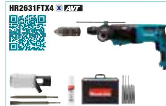
**HR2631FTX4** : 3 modes : perçage, perforation, burinage - 800 W - Ø béton/trépan/acier/bois 26/68/13/32 mm - 0 à 1200 tr/min. - 0 à 4600 cps/min. - 2,4 J - 3 kg. Livré avec 1 mandrin, 1 dustcup, 1 coffret de 5 forets, 1 pointe à béton, 1 burin plat, 1 graisse à foret en coffret alu
