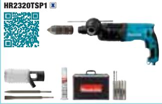
**HR2320TSP1** : 3 modes : perçage, perforation, burinage - 720 W - Ø béton/trépan/acier/bois 23/68/13/32 mm - 0 à 1200 tr/min. - 0 à 4600 cps/min. - 6,1 J - 6,6 kg. Livré avec 1 coffret de 5 forets, 1 pointe à béton, 1 burin plat, 1 graisse à foret, 1 dustcup en coffret métal
