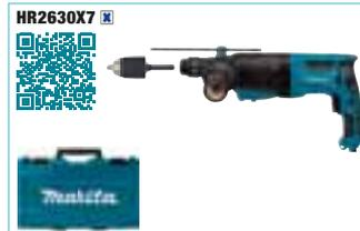
**HR2630X7** : 3 modes : perçage, perforation, burinage - 800 W - Ø béton/trépan/acier/bois 26/68/13/32 mm - 0 à 1200 tr/min. - 0 à 4600 cps/min. - 2,4 J - 5,4 kg Livré avec 1 mandrin autoserrant, en coffret
