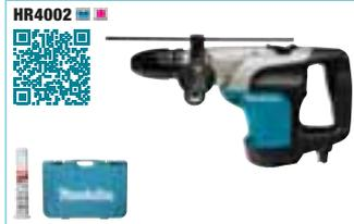
**HR4002** : 1050 W - Ø béton/trépan 40/105 mm 10,5 m/s<sup>2</sup> - 0 à 680 tr/min. - 0 à 2500 cps/min. 6,1 J - 6,6 kg. Livré avec 1 poignée, 1 graisse à foret en coffret
