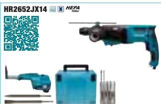
**HR2652JX14** : 3 modes : perçage, perforation, burinage - 800 W - Ø béton/trépan/acier/bois 26/68/13/32 mm - 0 à 1200 tr/min. - 0 à 4600 cps/min. - 2,2 J - 4,3 kg. Livré avec jeu de foret, 1 kit d'aspiration, 1 pointe, 1 burin, coffret MAKPAC
