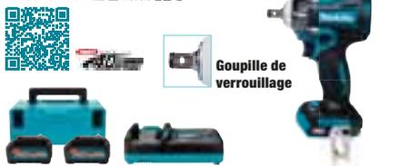
**TW004GD201** : Carré d'entraînement 1/2" - serrage 350 Nm - desserrage 630 Nm - M10 à M20 - 0 à 4000 cps/min - 0 à 3200 tr/min - 2,2 kg
