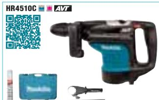
**HR4510C** : 1350 W - béton/trépan 45/125 mm 9,5 m/s<sup>2</sup> - 130 à 280 tr/min. - 1250 à 2750 cps/min. - 9,4 J - 8,9 kg. Livré avec 1 poignée, 1 graisse à foret, 1 poignée latérale en coffret
