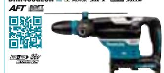
DHR400G2UN : Ø Béton/trépan : 40/105 mm - 2900 cps/min 8 J - 8,1 kg. Livré avec 1 poignée de perçage, 1 poignée de burinage, 1 butée de profondeur, grasse à foret 2 batteries 18V 6 Ah et 1 chargeur rapide double port
