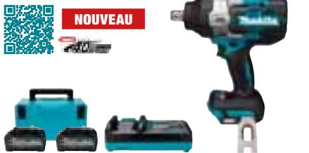
**TW001GM201** : Carré d'entraînement 3/4" - serrage 1800 Nm - desserrage 2050 Nm - M10 à M36 - 0 à 2500 cps/min - 0 à 1800 tr/min - 3,9 à 5,1 kg
