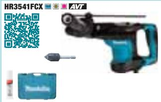
**HR3541FCX** : 850 W - Ø béton/trépan/acier/bois 35/90/13/32 mm - 11 m/s<sup>2</sup> - 315 à 630 tr/min. - 1650 - 3300 cps/min. - 6,1 J - 5,6 kg. Livré avec 1 graisse à foret et 1 mandrin en coffret
