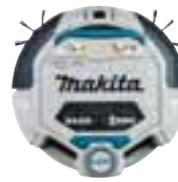
**DRC300Z** : Zone de cartographie maximale enregistrable : 10 000 m<sup>2</sup> - jusqu'à 4 heures d'autonomie avec 2 x BL1860B - de 9,6 à 10,6 kg
