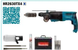
**HR2630TX4** : 3 modes : perçage, perforation, burinage - 800 W - Ø béton/trépan/acier/bois 26/68/13/32 mm - 0 à 1200 tr/min. - 0 à 4600 cps/min. - 2,4 J - 5,6 kg. Livré avec 1 mandrin, 1 dustcup, 1 coffret de 5 forets, 1 pointe à béton, 1 burin plat 1 graisse à foret en coffret alu
